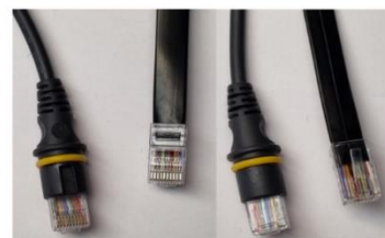
Ny kabel till vänster, utbytt kabel till
